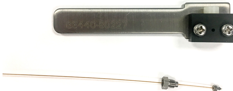
Figure 7. Enfilez la colonne grâce à l'écrou interne, la ferrule et la clé à sertir.
