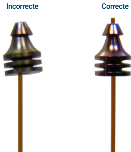
Figure 18. Symétrie de sertissage correcte et symétrie de sertissage incorrecte
