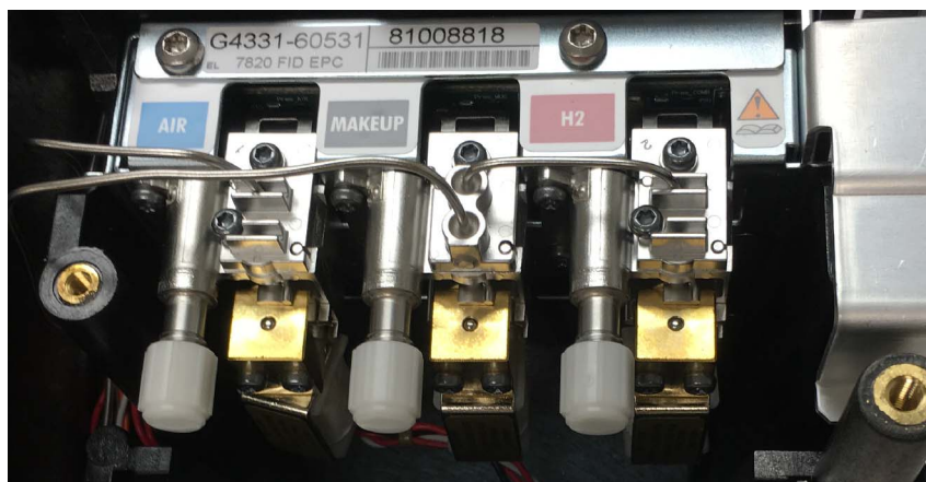
Figure 2 Exemple de module de flux EPC arrière avec une conduite DIF attachée
