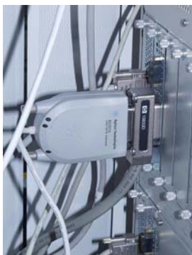
Figura 7 Conexión de la interfase USB-GPIB
