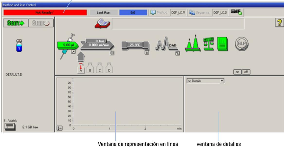
**Figura 10** Pantalla de inicio de ChemStation (Method and Run Control)
