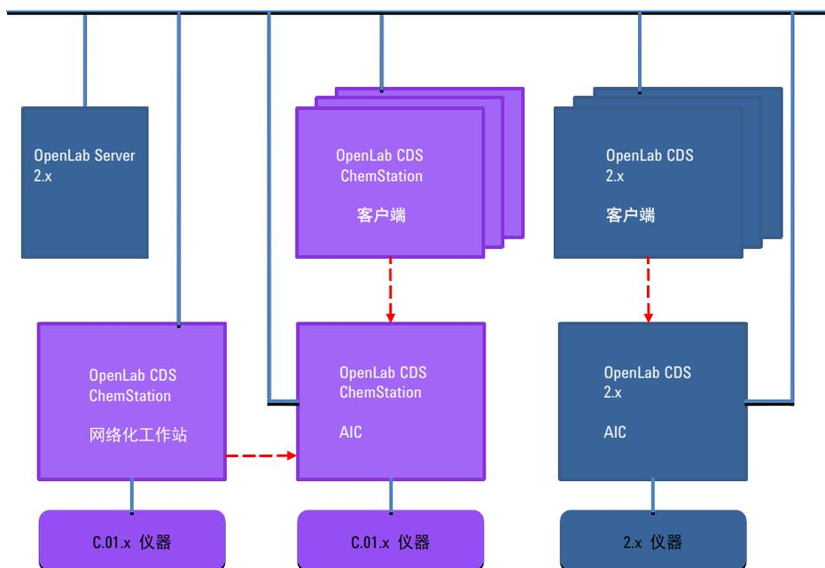
图 5 ChemStation C.01.09 和 OpenLab CDS 2.x 日常工作
