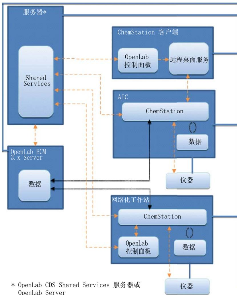
图 4 ChemStation 和 OpenLab ECM 3.x 的混合布局
