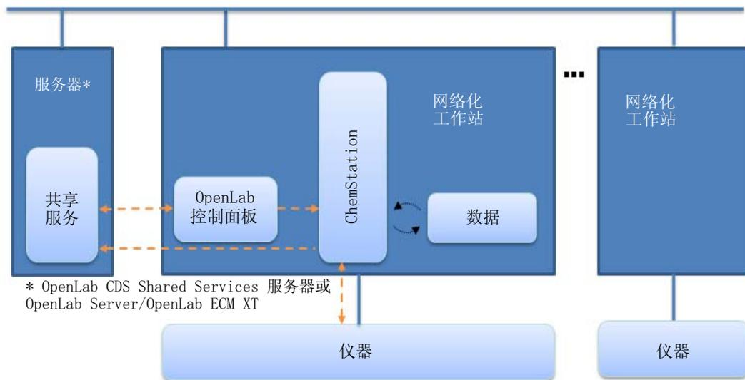
图 2 ChemStation 网络化工作站
