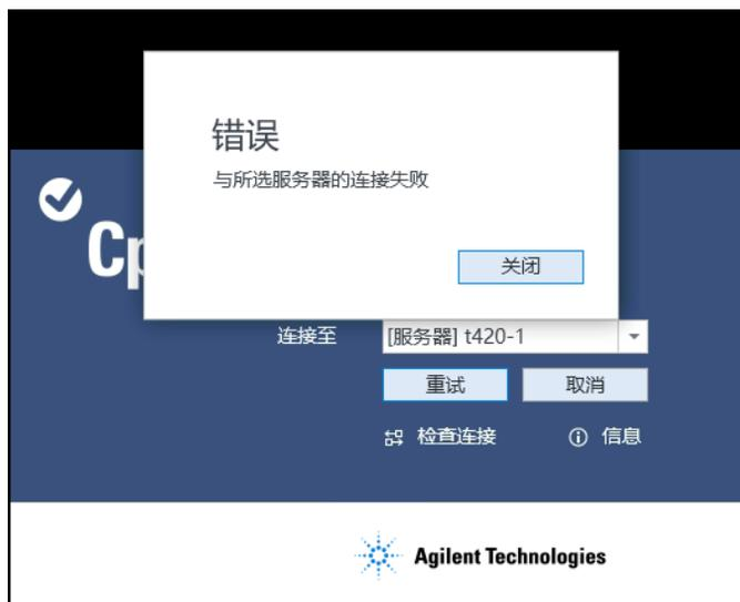
图 19 在不连接 OpenLab CDS Shared Services 服务器的情况下启动 OpenLab 控制面板
