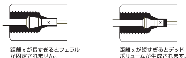
図 2. フェラルから突き出たチューブは長すぎても短すぎてもいけません
