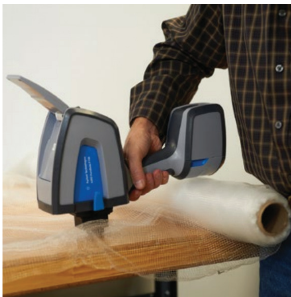
図 1. アジレントの 4300 ハンドヘルド FTIR でポリマーを容易に同定できます。
