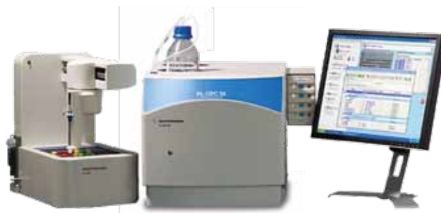
安捷伦 PL-GPC 50 一体式 GPC/SEC 系统。左侧为自动进样器, 右侧为显示器, 中间主机内安装了溶剂泵、柱温箱和检测器
