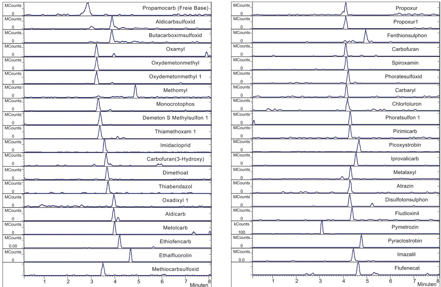
Abbildung 4 Schnelle Analytik mit Pursuit XRs Ultra 2.8 beim Screening von Pestiziden in Kindernahrung (mit 10 ppb Pestiziden gespickt; es werden hier nur 40 der 139 Pestizide gezeigt). Die mit dem Varian 320-MS LC/MS/MS-System durchgeführte Analytik dauert weniger als 5 Minuten.
