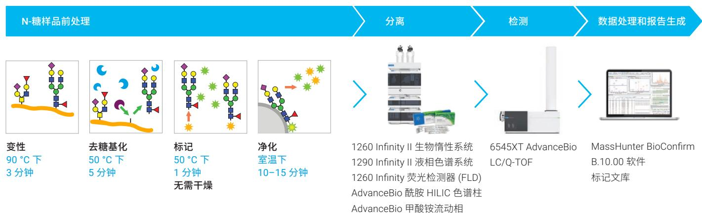
图 1. 使用 Gly-X InstantPC 样品前处理与 LC/FLD/MS 的游离 N-糖分析工作流程
