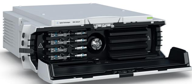
InfinityLab クイックコネクタカラムフィッティングを用いれば、すばやく簡単にカラムを交換できます。次世代の InfinityLab クイックコネクタ熱交換器の接続や交換も容易です。
