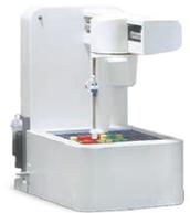
PL-GPC 50 자동 시료 주입기(autosampler)는 XY 축으로 움직이는, 대기 온도에서 작동하며 156개 바이알의 용량을 갖추고 있습니다. 시료 주입량은 세척된 고정 루프를 통해 이루어지며, 최대 250µL의 주입에 대해 탁월한 재현성을 제공합니다. 소프트웨어 제어 기능은 유연성을 더해 자동화된 세척 사이클이나, 실험실 생산성 극대화를 위한 바이알당 최대 9회의 주입 등을 프로그래밍할 수 있도록 합니다.
