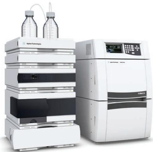
Agilent 1260 Infinity Multi-Detector GPC/SEC 시스템은 LC 모듈의 정밀도를 Multi-Detector Suite가 제공하는 정확하고 풍부한 정보의 데이터와 조합합니다.
