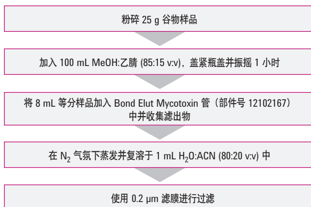
图 2. 适用于谷物中霉菌毒素的 Bond Elut Mycotoxin SPE 样品制备方法
