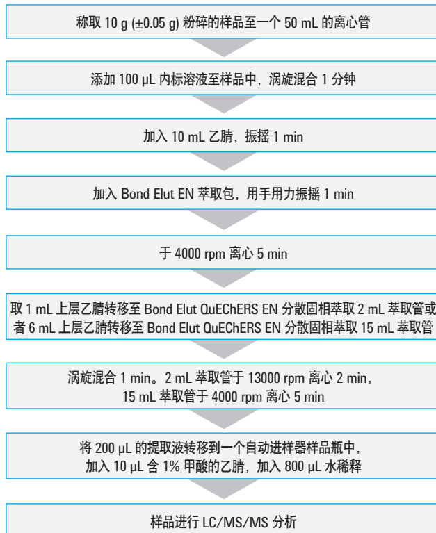
图 1. QuEChERS EN 样品制备流程图
