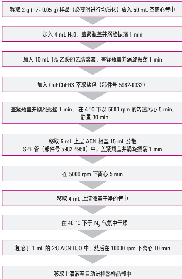
图 1. 适用于动物源食品中兽药的 QuEChERS AOAC 样品制备程序
