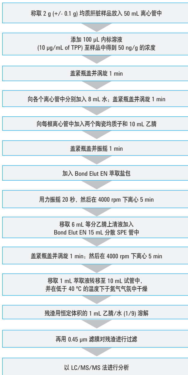
图 1. 用于分析绿茶中农药残留的 QuEChERS EN 操作程序
