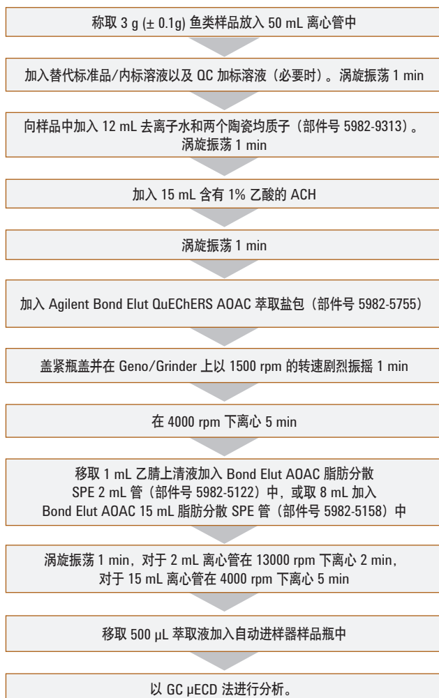
图 1. 适用于鱼类样品的 Agilent Bond Elut QuEChERS 改进的 AOAC 萃取程序
