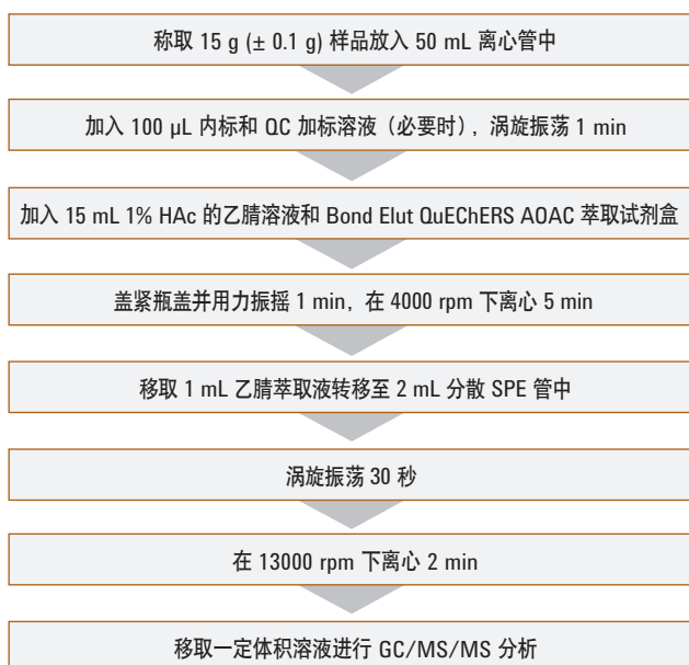
图 1. 适用于种植作物的 QuEChERS AOAC 萃取程序
