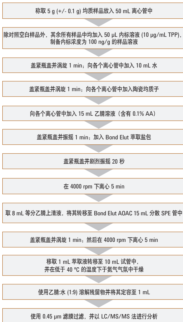
图 1. 适用于大米样品的 Agilent QuEChERS 萃取程序
