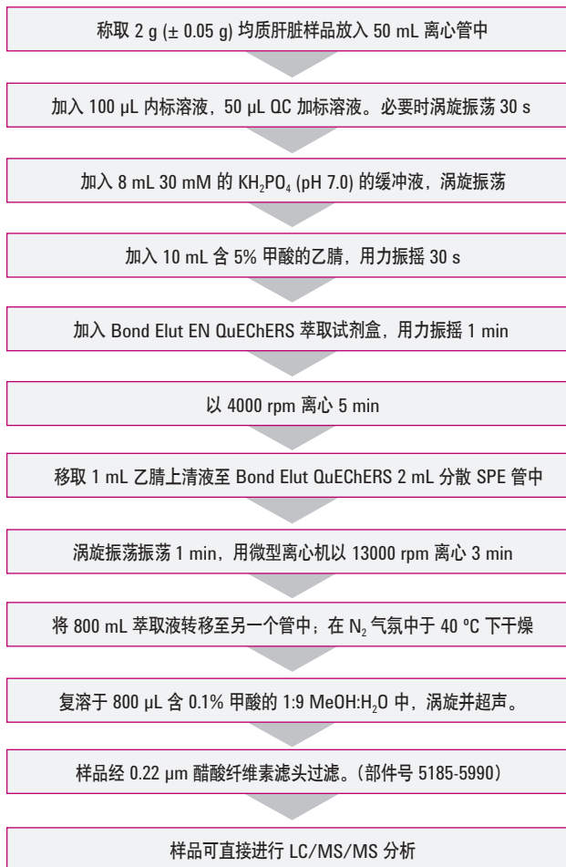
图 1: Agilent QuEChERS 抗生素萃取流程图
