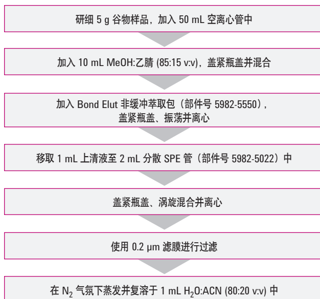
图 1. 适用于谷物的 QuEChERS AOAC 样品制备程序
