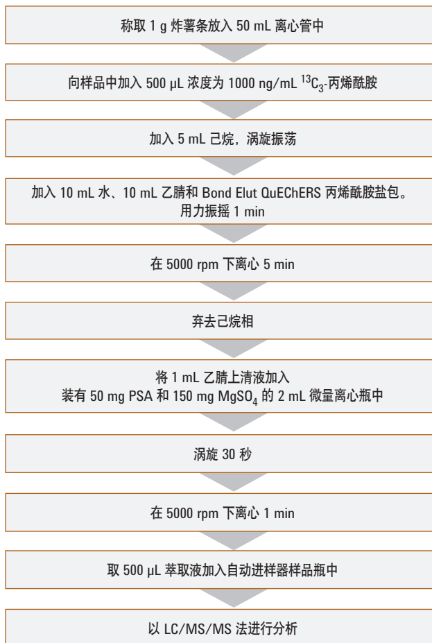
图 1. 适用于炸薯条中丙烯酰胺分析的 QuEChERS 样品制备程序
