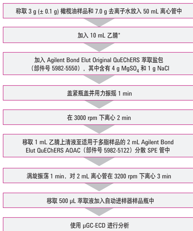
图 1. 适用于分析橄榄油中农药残留的 Agilent QuEChERS 操作程序
