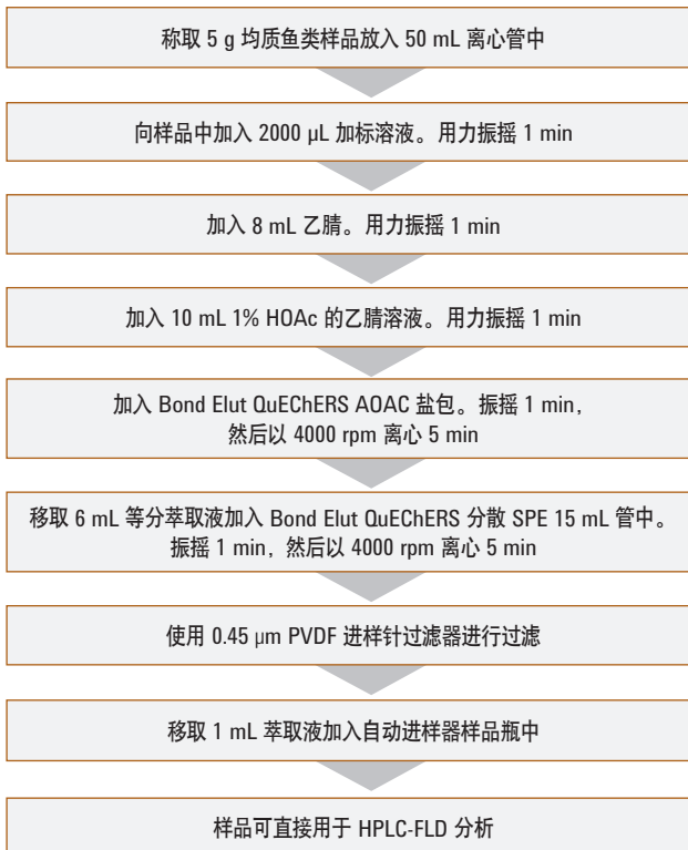
图 1. 用于分析鱼类中 PAH 残留的 QuEChERS AOAC 样品制备程序
