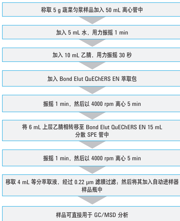
图 1. 用于分析茄果类蔬菜中农药残留的 QuEChERS EN 操作程序
