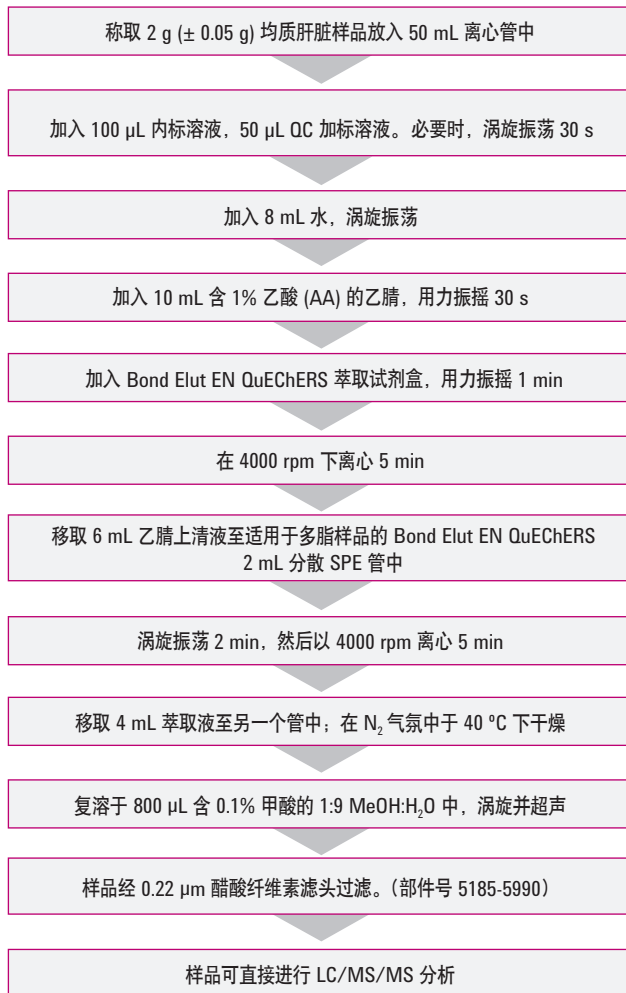
图 1. 适用于牛肝脏中九种磺胺类抗生素的 Agilent QuEChERS 操作程序
