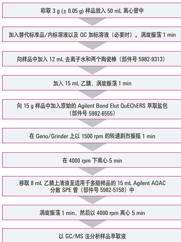
图 1. Agilent Bond Elut QuEChERS 改进的适用于鱼类样品的萃取程序
