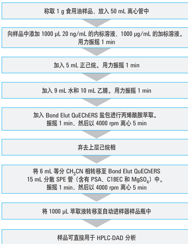
图 1. 适用于食用油中丙烯酰胺分析的 QuEChERS 样品制备程序
