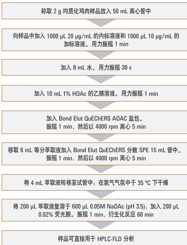
图 1. 用于分析鸡肉中磺胺类药物残留的 QuEChERS AOAC 样品制备程序
