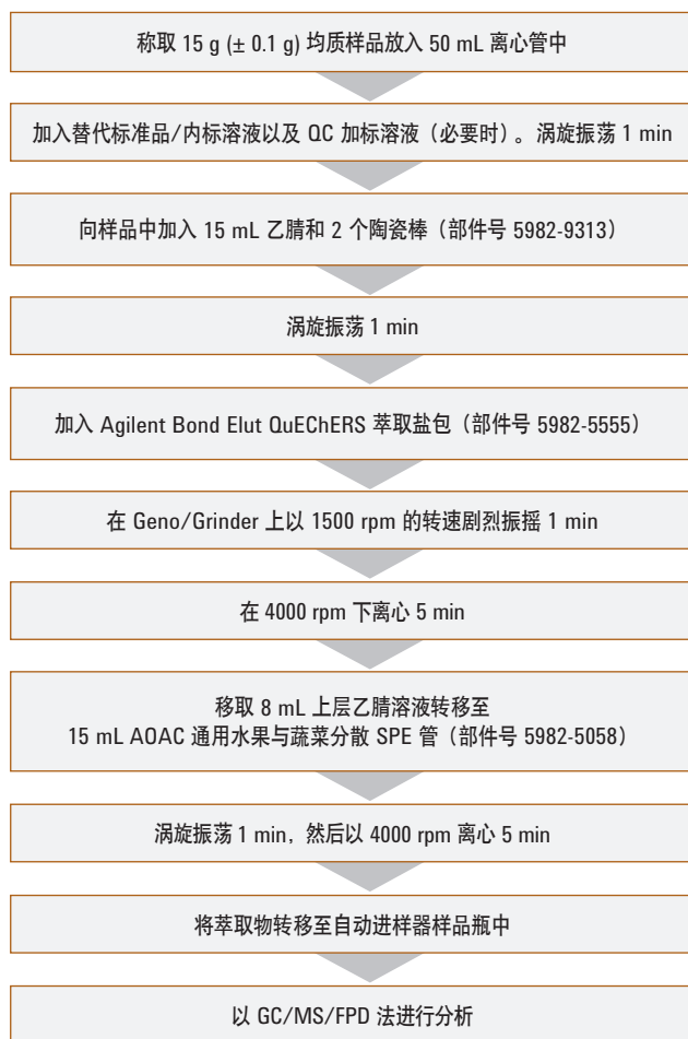
图 1. 适用于苹果样品的 Agilent QuEChERS 萃取程序
