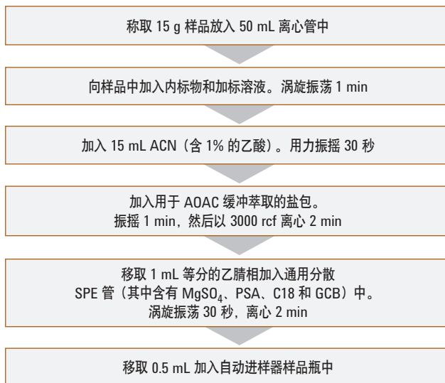
图 1. 适用于分析生菜和苹果中农药残留的 QuEChERS 样品制备程序
