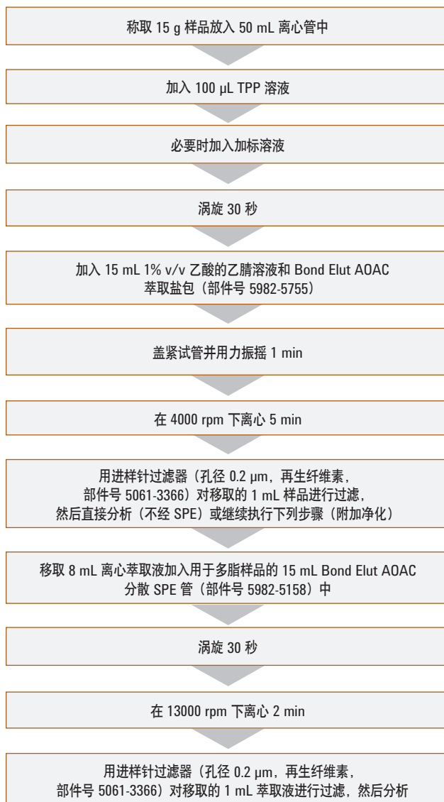
图 1. 婴儿食品中农药残留的 Agilent Bond Elut QuEChERS AOAC 萃取操作程序
