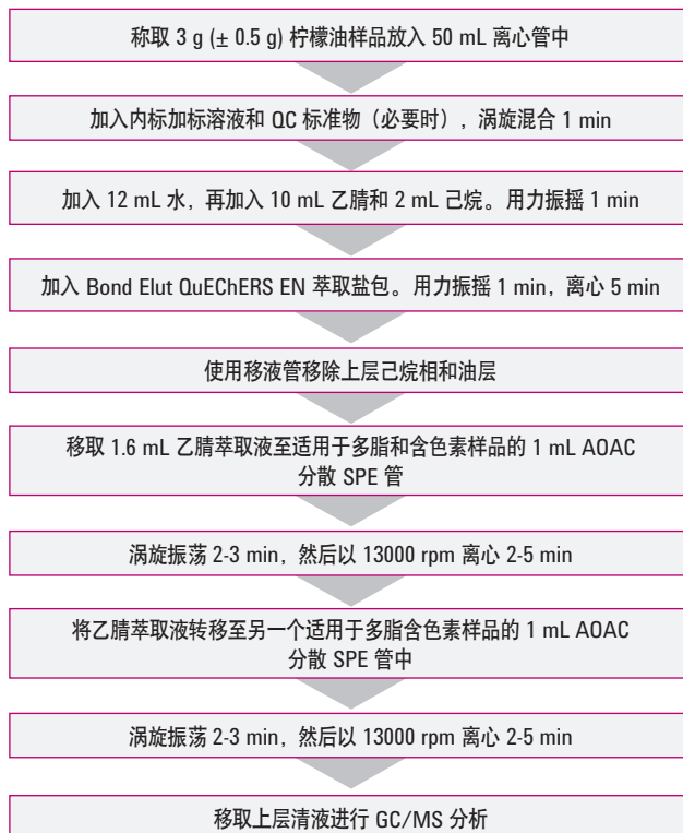
图 1. 适用于柠檬油中农药残留的安捷伦改进的 QuEChERS EN 操作程序
