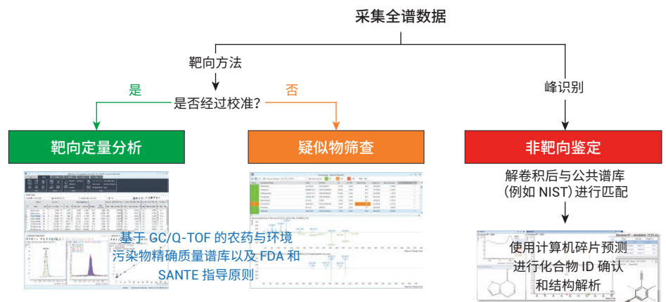
图 2. 污染物筛查工作流程，结合了使用 GC/Q-TOF PCDL 的靶向和疑似物筛查方法以及使用 NIST 谱库且随后进行未知物结构解析的非靶向筛查
