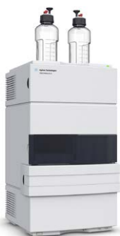
1220 Infinity II LC 无限超值 600 bar, 10 mL/min 80 Hz 高性价比 可运行 HPLC 和 UHPLC 方法 部分采用 1260/1290 技术
