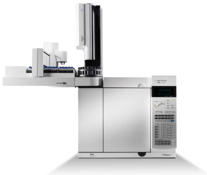
配备 7693A 系列自动液体进样器的安捷伦 7890A 气相色谱
