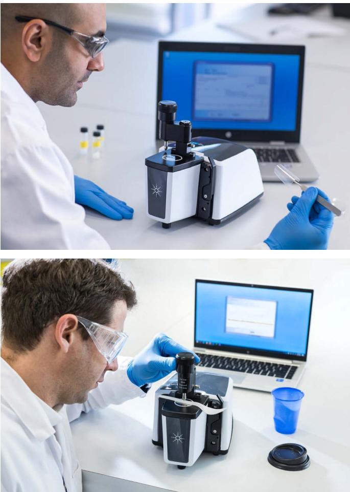
图 3. 使用配备 ATR 采样附件的 Agilent Cary 630 FTIR 分析塑料薄膜和塑料废弃物
