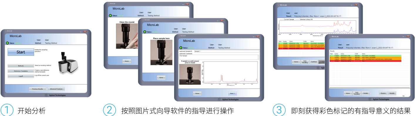
图 2. 使用 Agilent MicroLab 软件和 Agilent Cary 630 FTIR，通过三个简单的步骤简化分析和塑料鉴定。图片式向导软件减少了培训需求，同时尽可能降低用户引起错误的风险
