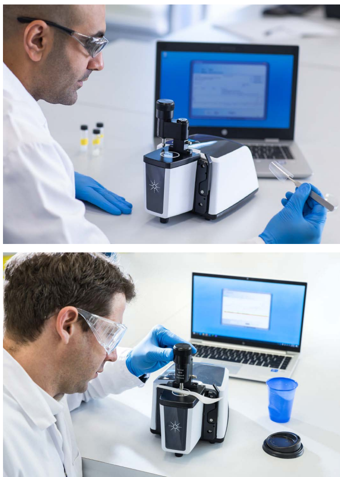
그림 3. ATR 샘플링 모듈이 장착된 Agilent Cary 630 FTIR을 이용한 플라스틱 필름 및 플라스틱 폐기물 분석.
