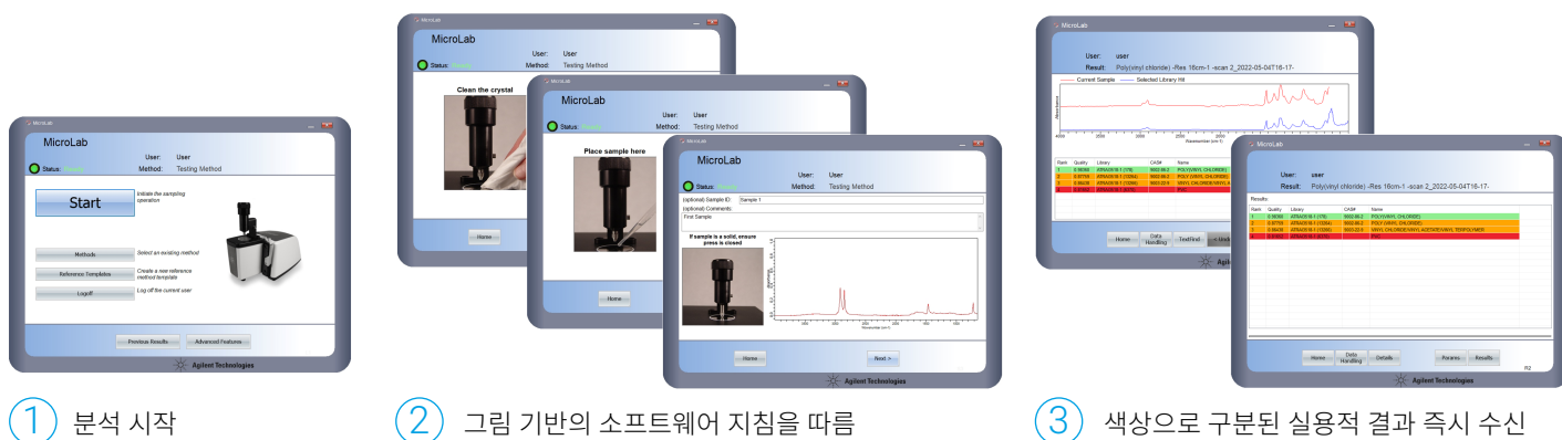
그림 2. Agilent MicroLab 소프트웨어와 Agilent Cary 630 FTIR을 사용하여 분석을 간단하게 수행하고 플라스틱 식별을 단순화하는 세 가지 간단한 단계. 그림을 통해 안내되는 이 소프트웨어는 교육의 필요성을 줄여주고 사용자의 오류 위험을 최소화합니다.
