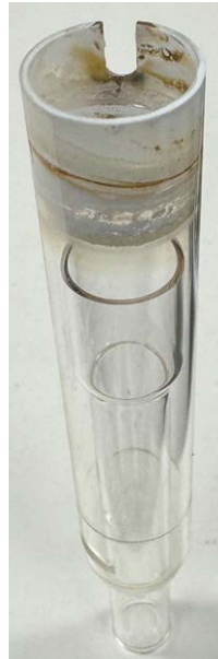
그림 1. 5% HNO 3 용액에 Li, Na, Cs를 1.5% TDS 농도로 첨가하여 24시간 동안 분석한 후 석영 외부 튜브 세트에 발생한 탈유리화.
