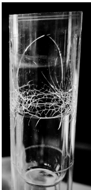
Figura 4. Rottura della ragnatela in un vessel al quarzo.
