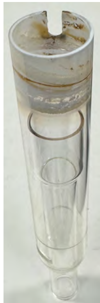
Figura 1. Devetrificazione di un set di tubi esterni al quarzo dopo 24 ore di analisi di una soluzione TDS all'1,5% di Li, Na, Cs in \text{HNO}_3 al 5%.
