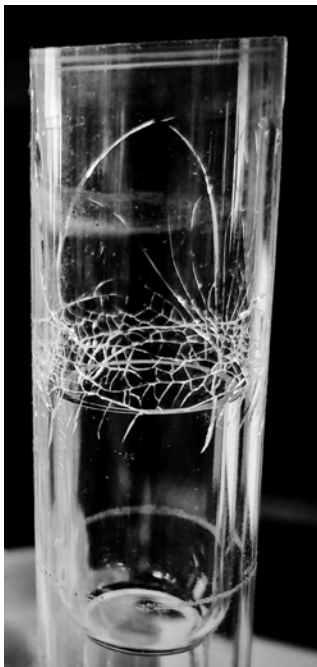
Figure 4. Fissure en forme de toile d'araignée dans un bol en quartz.
