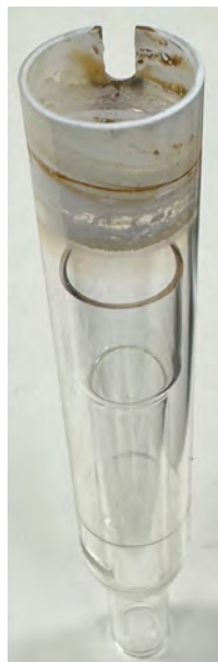
Abbildung 1. Entglasung eines Quarz-Außenrohr-Sets nach 24-stündiger Analyse einer 1,5%igen Lösung mit hoher Salzfracht von Li, Na und Cs in 5%iger \text{HNO}_3 .
