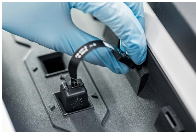
图 15. 将温度探头接头插入仪器
