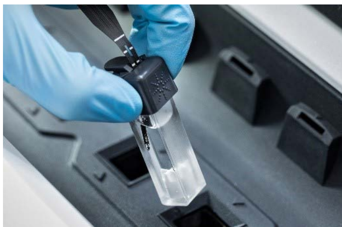
图 11. Cary 比色皿内温度探头具有低质量、大表面积和超快速反馈回路的特点
