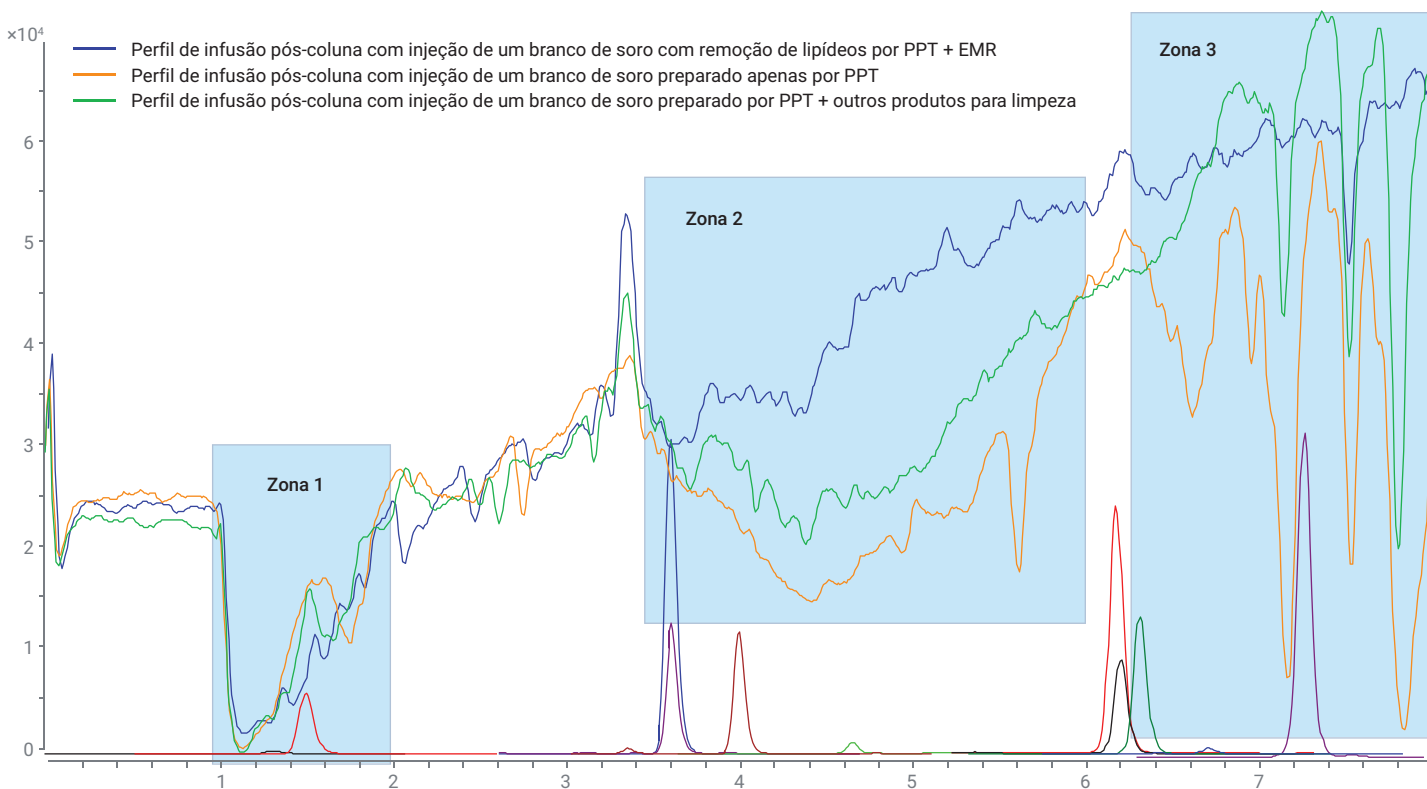
Figura 4. Comparação de perfis de infusão pós-coluna padrão e demonstração da supressão de íons da matriz em analitos-alvo.
