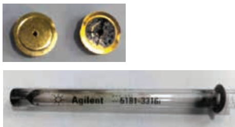
Figura 1. Contaminazione di componenti del sistema GC a seguito di una routine di preparazione del campione "sufficiente".
