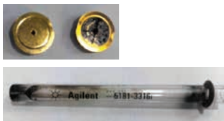
Figure 1 : Contamination des composants d'un système de GC par un échantillon préparé selon une méthode « satisfaisante ».
