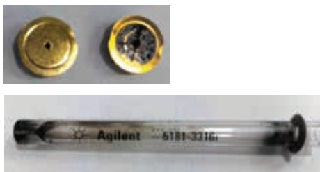
Figura 1. Contaminación de componentes de un sistema GC producida por una rutina de preparación de muestras "suficientemente buena".
