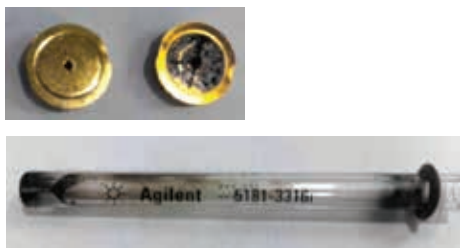
Abbildung 1: Kontamination von GC-Systemkomponenten durch eine Probenvorbereitungsroutine, die „gut genug“ ist.
