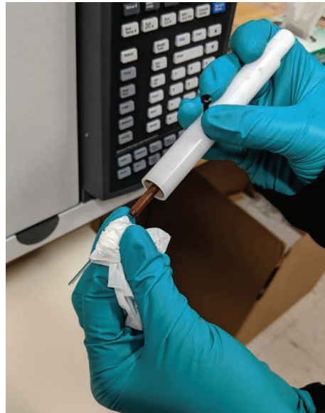
그림 30. 시료를 추가한 후 캐리오버 가능성을 줄이기 위해 보풀 없는 천을 사용해 유리 프로브 측면 청소
