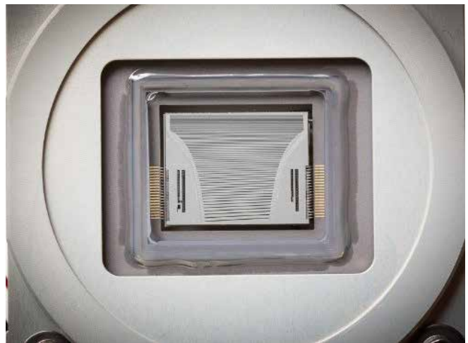
Figura 7. Il rivelatore è sigillato ermeticamente e, pertanto, non richiede lo spurgo con argon per le misure nell'intervallo di lunghezze d'onda UV. La tenuta ermetica, inoltre, prolunga la durata utile del rivelatore.
