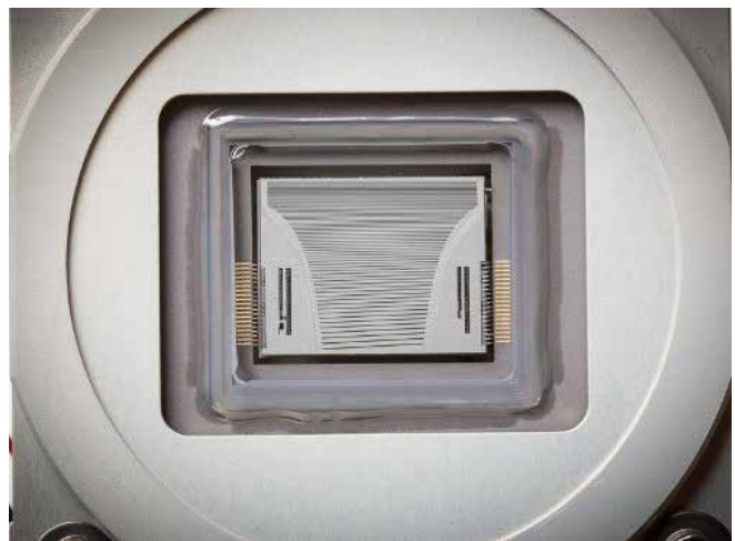
Figure 7 : Le détecteur est scellé hermétiquement. Aucune purge à l'argon n'est donc nécessaire lors de la mesure des longueurs d'onde UV. Le joint prolonge également la durée de vie du détecteur.
