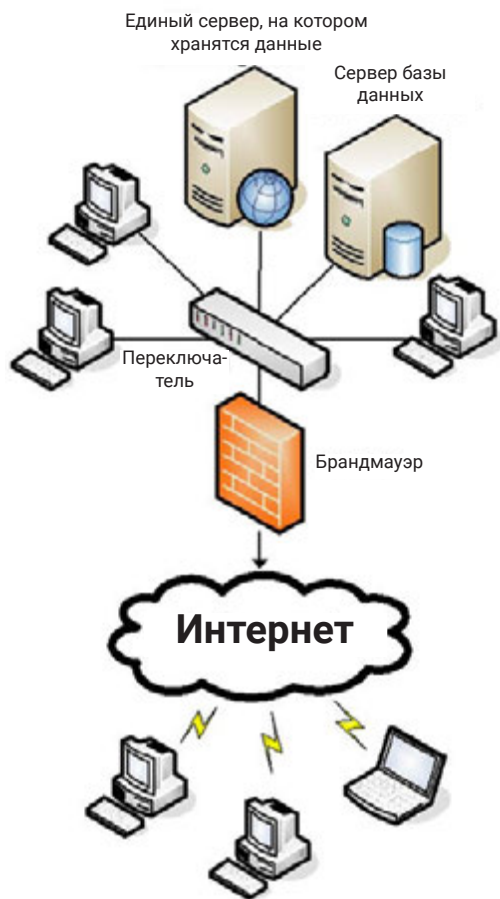
Рисунок 5. Схема конфигурации единого сервера OpenLab ECM. Поддерживаются различные варианты конфигурации сервера, от единого типа до гибкой установки с несколькими серверами.
