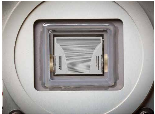
Figura 7. El detector está sellado herméticamente, lo que evita tener que realizar una purga con argón para medir longitudes de onda del espectro UV. Además, el sello prolonga la vida útil del detector.
