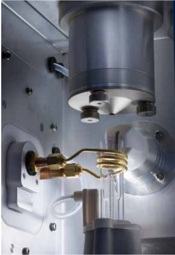
Figura 5. La antorcha vertical del sistema ICP-OES Agilent 5110 tiene una configuración idónea para muestras con altos niveles de sólidos disueltos, que a menudo forman depósitos en las antorchas horizontales.
