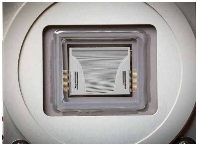
Abbildung 7. Der Detektor ist hermetisch gekapselt. Daher ist bei Messung von Wellenlängen im UV-Bereich keine Reinigung mit Argon notwendig. Die Dichtung verlängert die Lebensdauer des Detektors.
