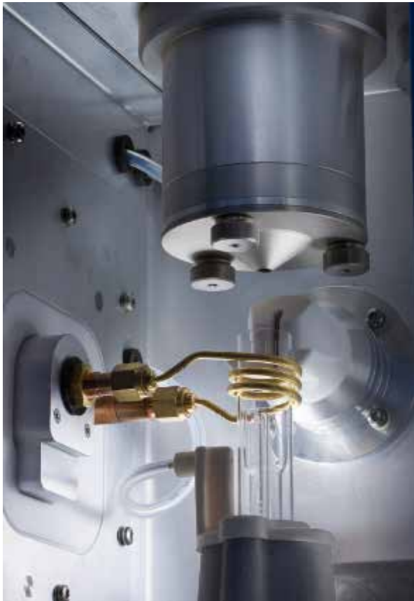
Abbildung 5. Der vertikale Torch des Agilent 5110 ist die ideale Konfiguration für Proben mit hohem Gehalt an gelösten Feststoffen, die auf horizontalen Torchtes oft Ablagerungen zurücklassen.
