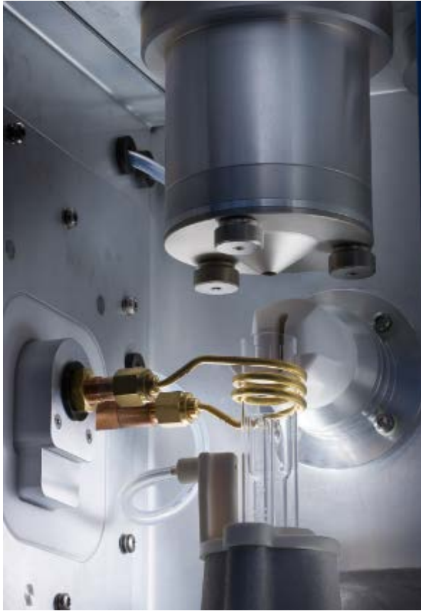
图 5. 5110 系统的垂直炬管非常适用于含有高浓度溶解态固体的样品，这种样品通常会在水平炬管上沉积
