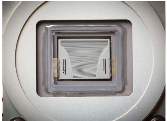
图 7. 检测器经严格密封，因此在测定紫外波长时无需氦气吹扫。这一密封性还延长了检测器寿命
