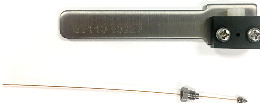
Figura 9. Pase la columna por la tuerca interna, la férula y la herramienta de conexión
