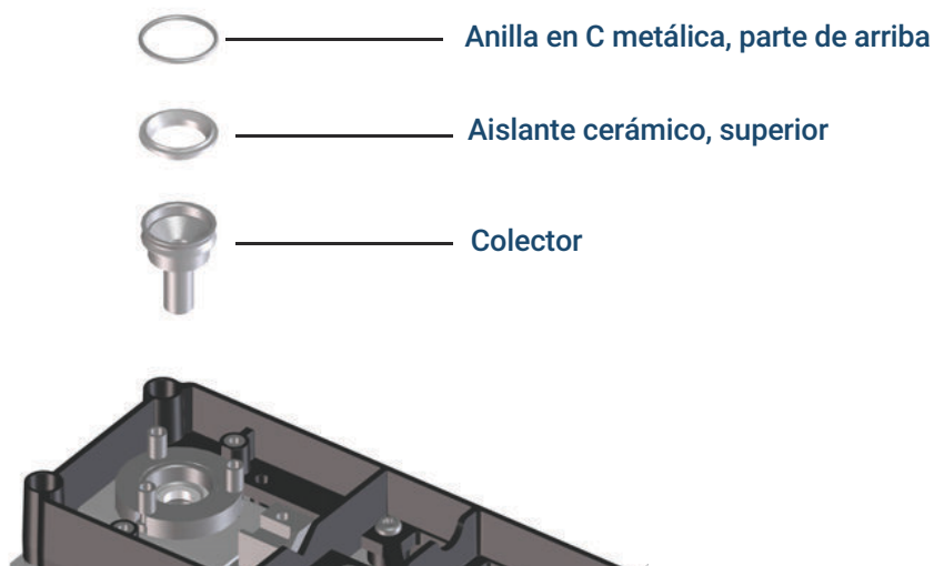
Figura 48. Colector del NPD, aislante superior y anilla metálica en C
