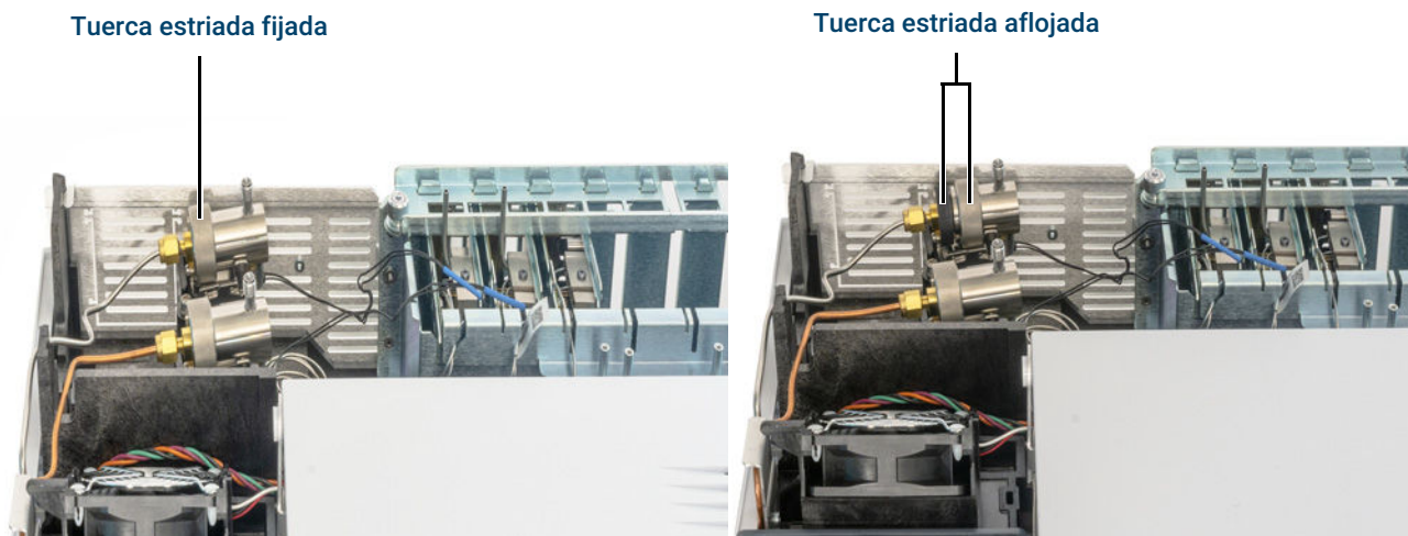
Figura 36. Afloje la tuerca estriada
