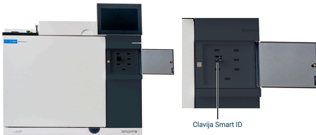
Figura 27. Inserte la clavija Smart ID
