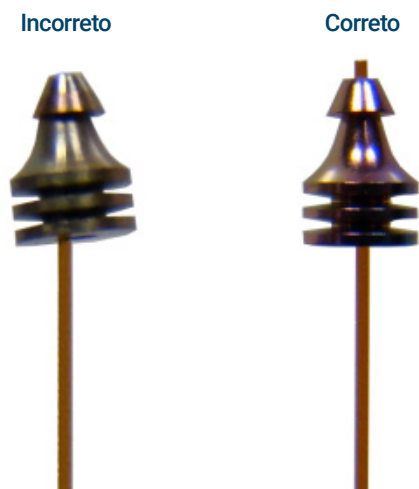
Figura 18. Simetria de acoplamento incorreta e correta
