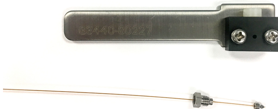
Figura 7. Passe a coluna pela porca interna, pela anilha e pela ferramenta de estampagem
