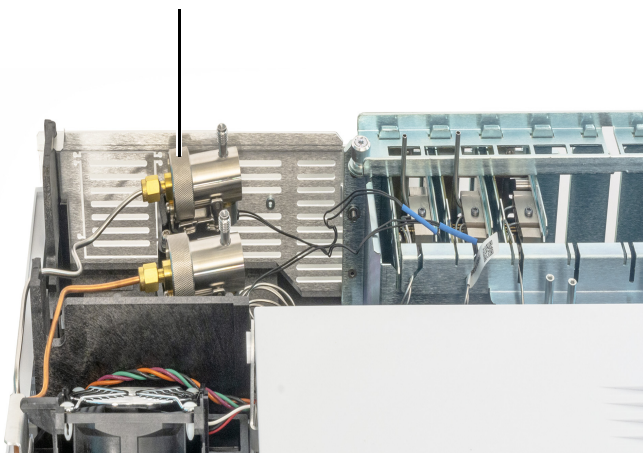
図 22. ローレットナットを緩める
