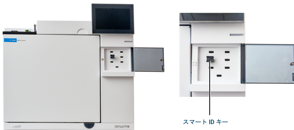
図 33. スマート ID キーの取り付け
