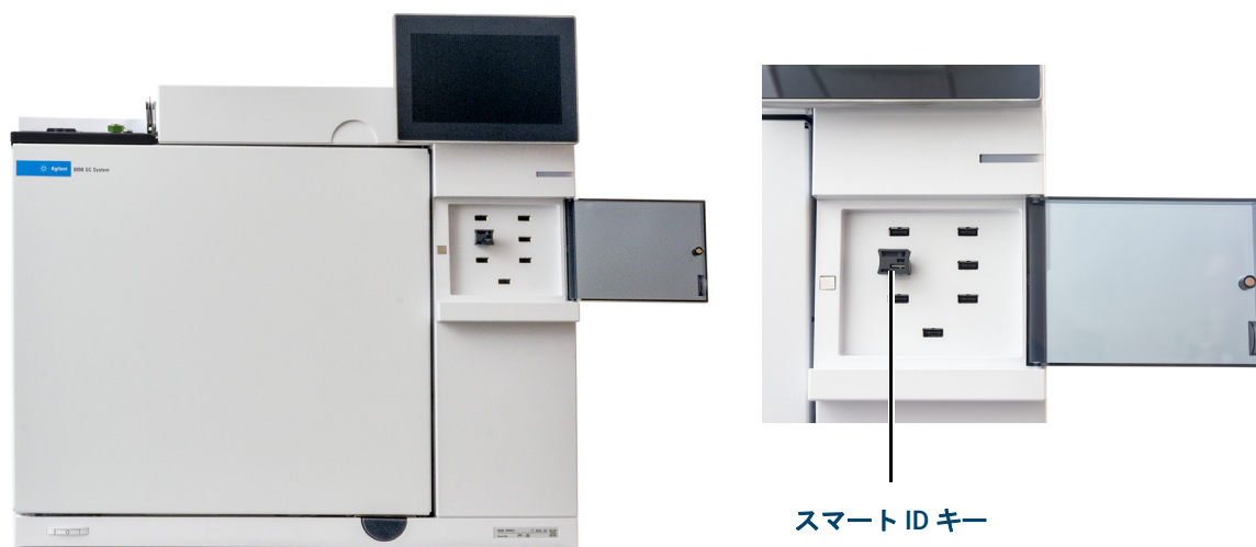
図 29. スマート ID キーの取り付け
