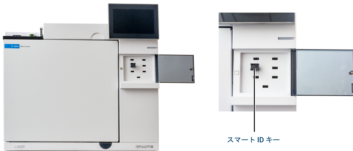
図37. スマートIDキーの取り付け
