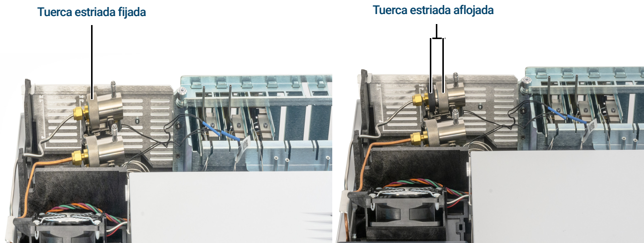
Figura 30. Afloje la tuerca estriada
