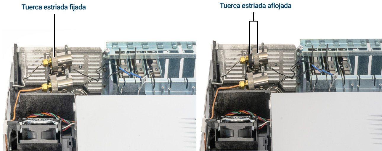
Figura 38. Afloje la tuerca estriada
