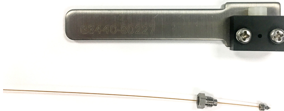
Figura 7. Pase la columna por la tuerca interna, la férula y la herramienta de conexión
