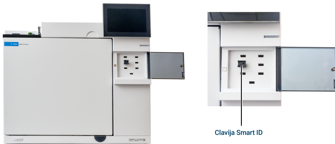
Figura 37. Inserte clavija Smart ID
