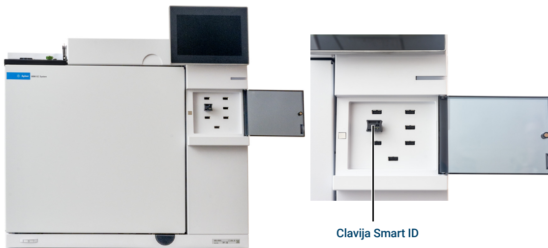
Figura 21. Inserte clavija Smart ID
