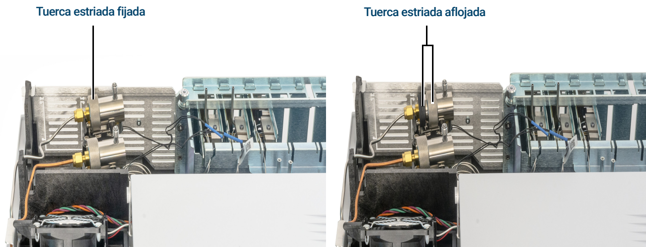
Figura 22. Afloje la tuerca estriada
