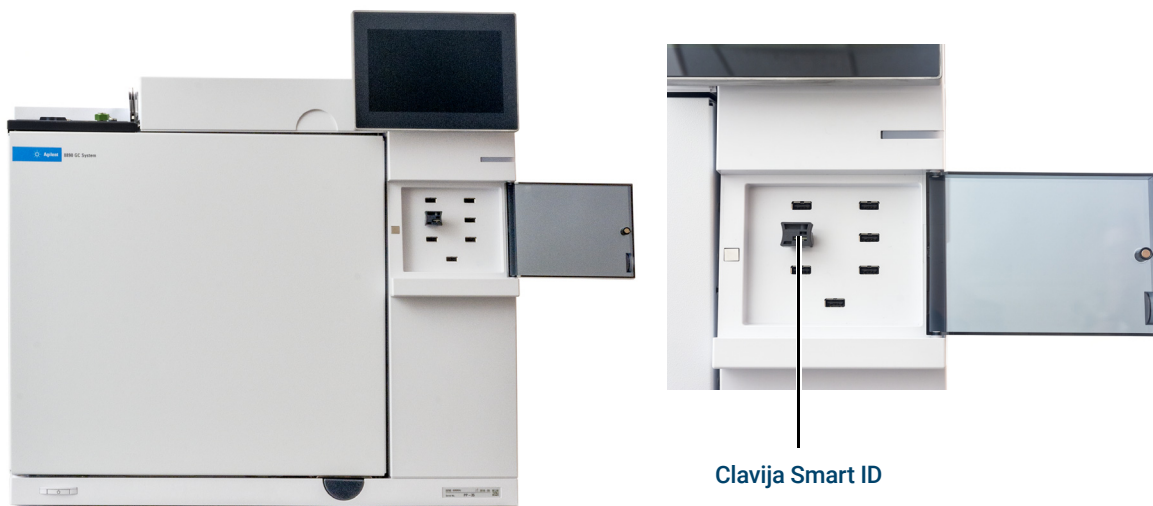
Figura 25. Inserte clavija Smart ID
