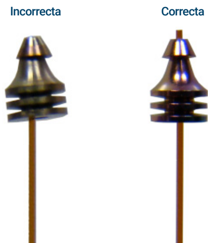
Figura 18. Simetría de conexión incorrecta y correcta
