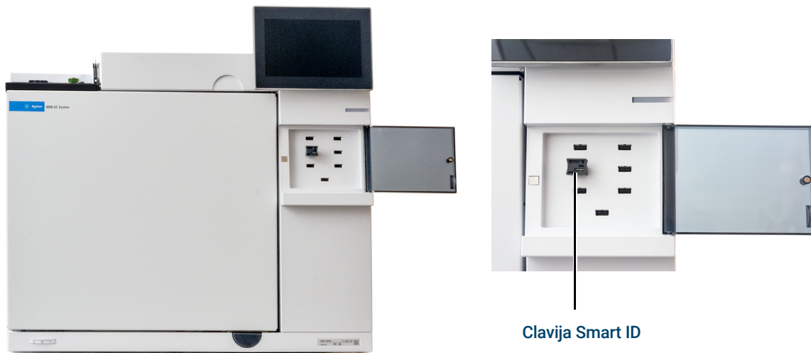
Figura 29. Inserte la clavija Smart ID
