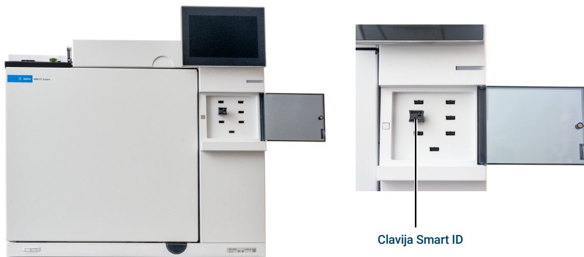
Figura 33. Inserte clavija Smart ID
