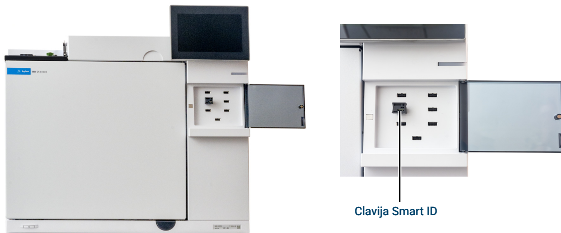
Figura 27. Inserte clavija Smart ID
