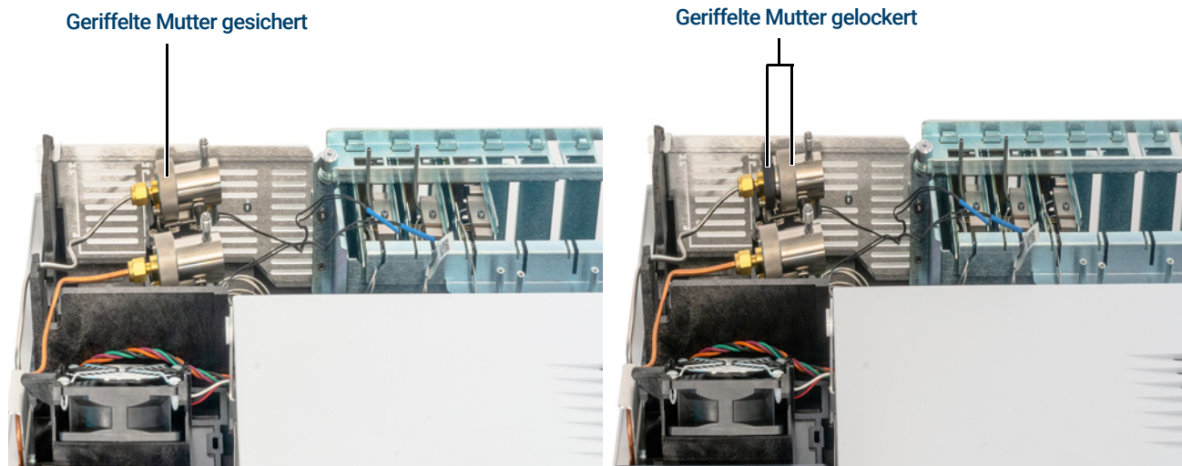
Abbildung 38. Geriffelte Mutter lockern
