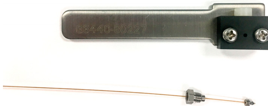
Abbildung 7. Einschrauben der Säule durch das Muttergewinde, die Ferrule und das Einwalzwerkzeug
