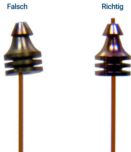
Abbildung 18. Falsche und richtige Einwalzsymmetrie
