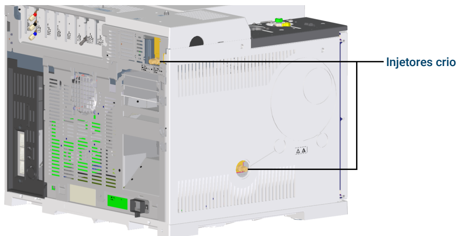
Figura 15. Local da válvula de resfriamento criogênico
