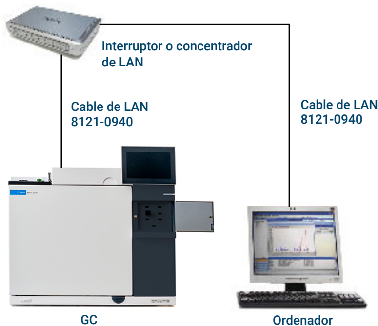
Figura 5. Configuración de LAN simples admitidas: Interruptor o concentrador de LAN
