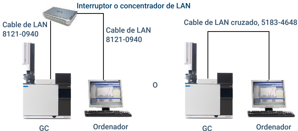
Figura 14. Configuraciones de LAN simples admitidas: Conmutador o concentrador LAN (izquierda) y conexión directa (derecha)
