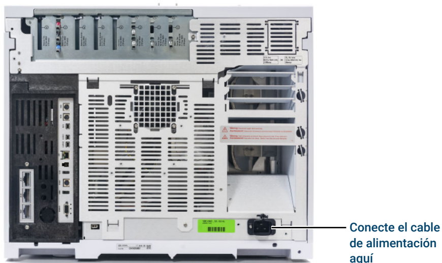
Figura 7. Ubicación del cable de alimentación
