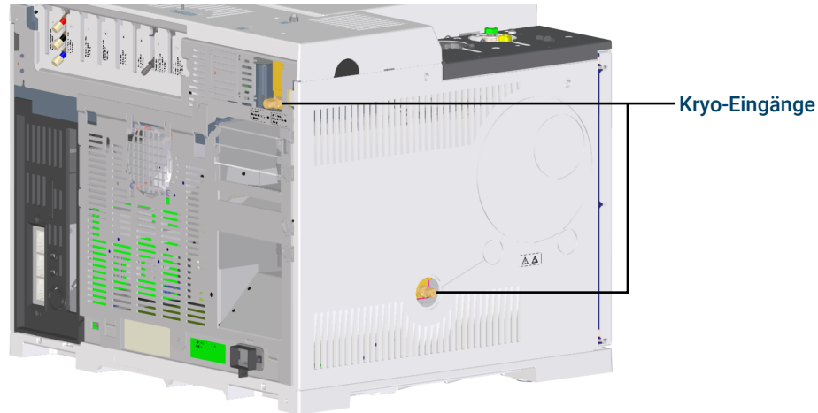
Abbildung 15. Position des Ventils für Tieftemperaturkühlung
