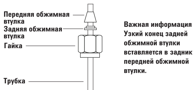
Рис. 16. Ферулы и гайки Swagelok
