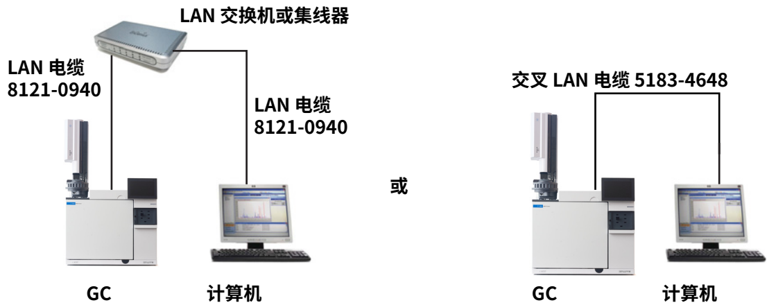
图 12. 简单支持的 LAN 配置：LAN 交换机或集线器（左）和直连（右）
