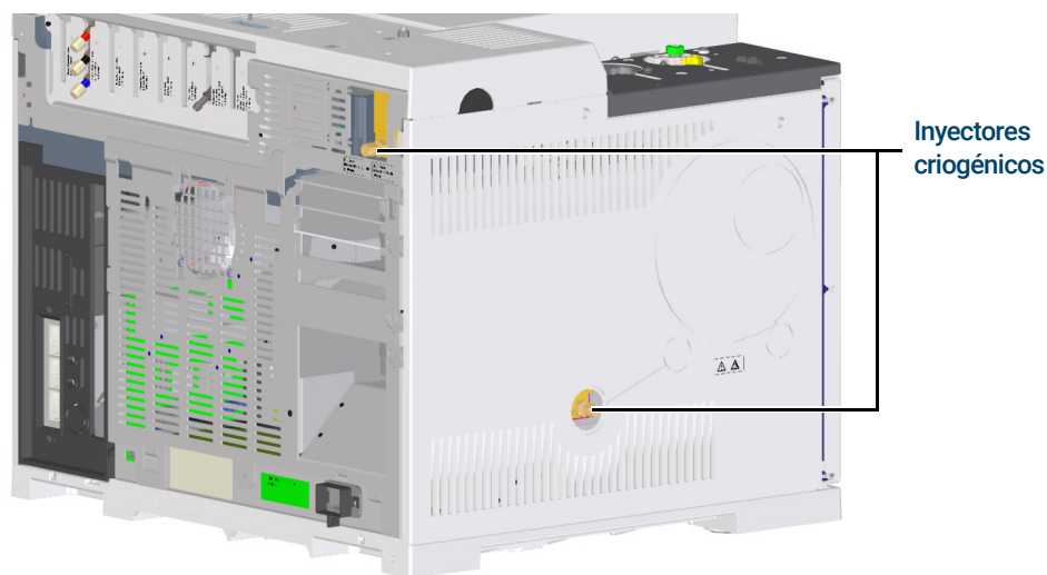
Figura 13. Ubicación de la válvula de enfriamiento criogénico
