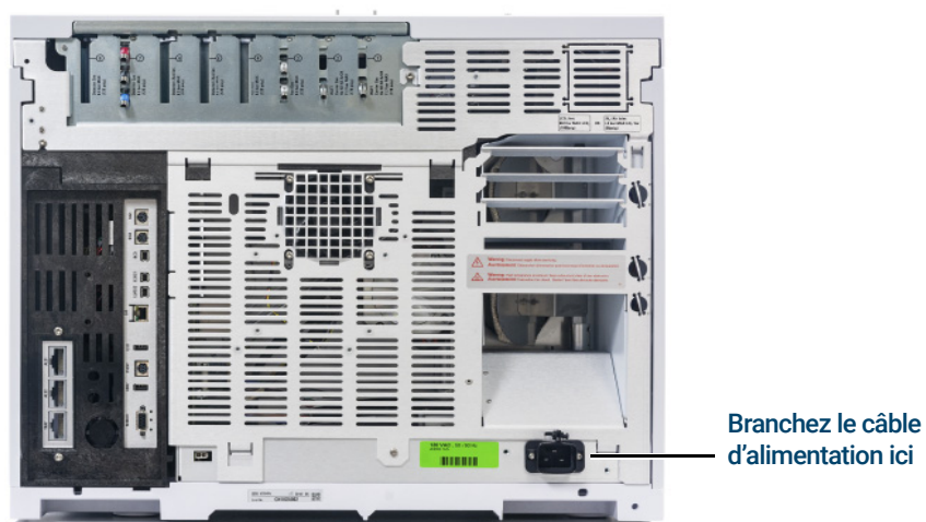
Figure 7. Emplacement du câble d'alimentation
