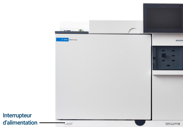
Figure 6. Emplacement de l'interrupteur d'alimentation
