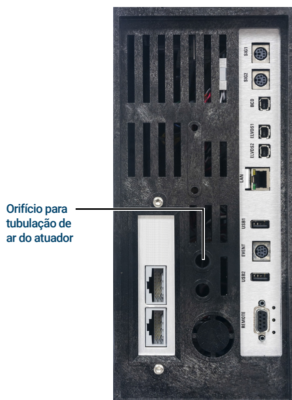
Figura 13. Tubulação de ar do atuador da válvula
