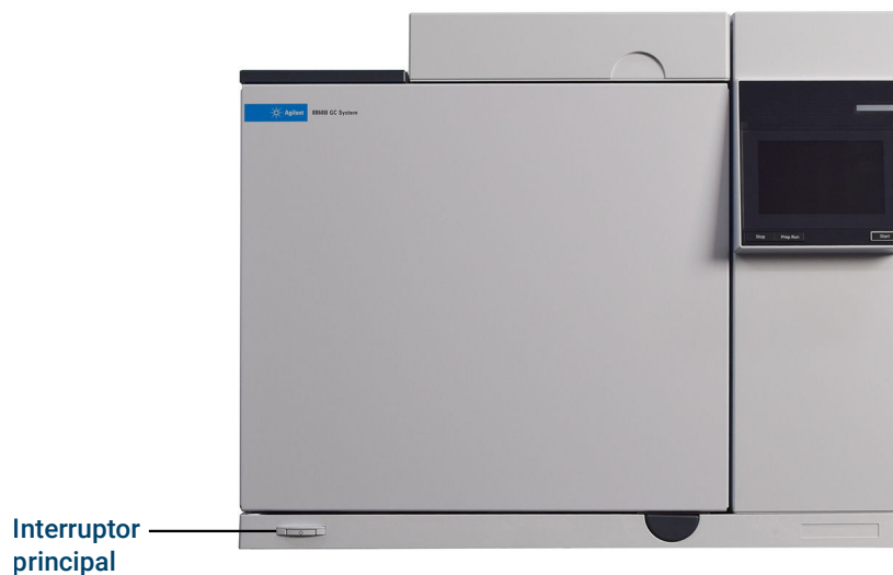
Figura 6. Ubicación del interruptor principal
