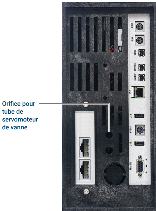
Figure 15. Arrivée d'air pour servomoteur de vanne
